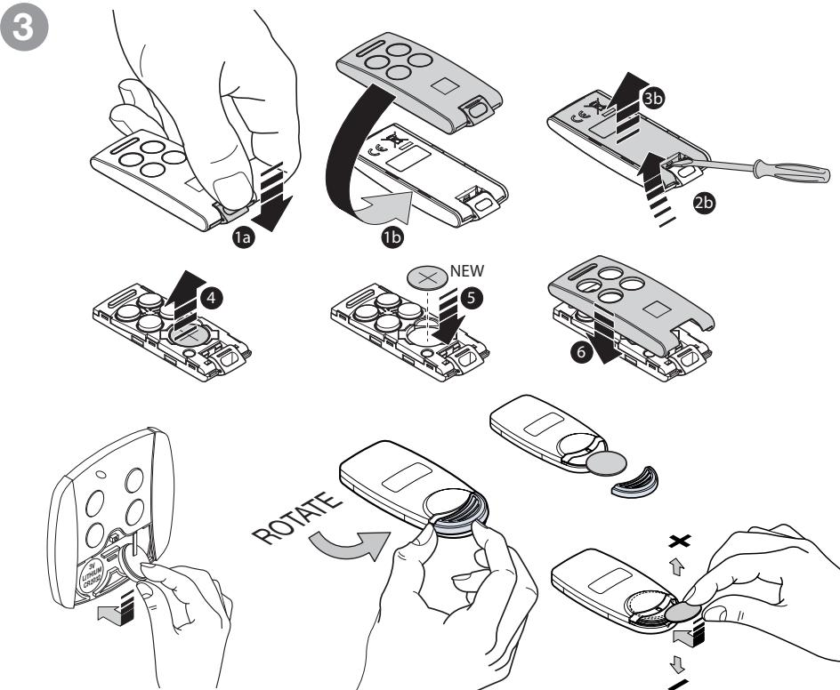
Batteria litio - Lithium battery - Batterie lithium - Lithiumbatterie - Batería litio: **3V 1 x CR2032**
