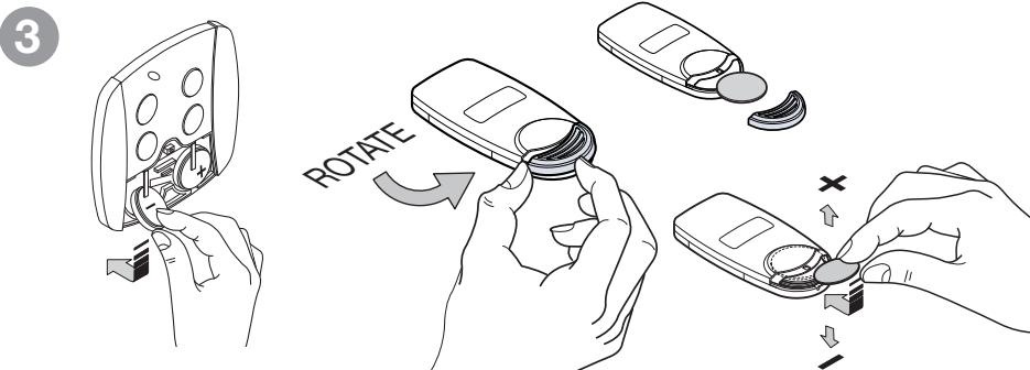
Batteria litio - Lithium battery - Batterie lithium - Lithiumbatterie - Batería litio: **3V 1 x CR2032**
