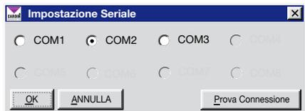
Questa funzione permette di selezionare la porta seriale per la comunicazione con l'MPI e di controllare l'effettivo collegamento con il tasto "**Prova Connessione**".
