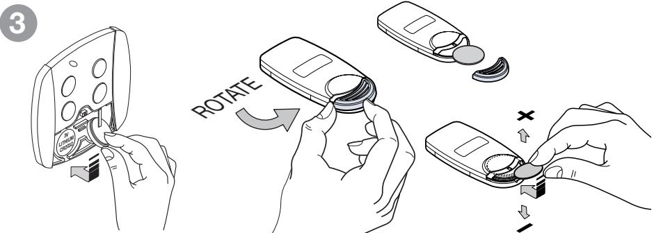
Batteria litio - Lithium battery - Batterie lithium - Lithiumbatterie - Batería litio: **3V 1 x CR2032**
